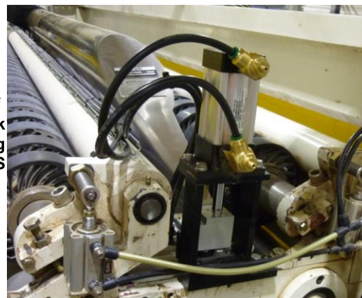
Individuelle Konstruktion des unteren Absaugkopfes unter Berücksichtigung der Trimbehälter
